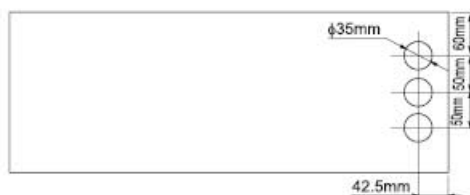
顶部进线敲落孔示意图 Diagram of top inlet knocking hole
