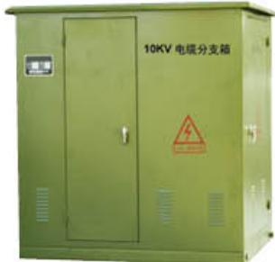
DFW8-12/630 系列带负荷开关的电缆分接箱，采用 SF6 气体绝缘的三工位负荷开关，开关进出线由套管引出，外接美式可欧式全绝缘电缆接头，适用于 3-12kV 地下电缆配电系统。该分支箱既保留了传统分支箱的优点，又具有环网柜的部分优点，是城网改造的理想设备。
