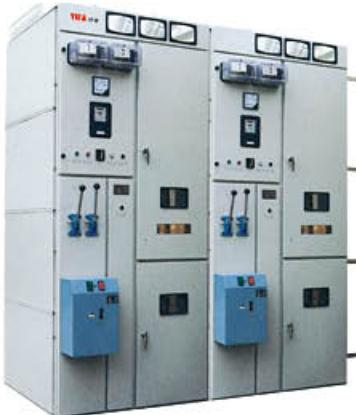
GG-1A(FZ)-12Z 智能型固定式高压开关柜适用于 3.6~12KV 电压等级、采用单母线和单母线分段主接线方式的电网变电所、工矿企业、码头、油田、铁路、住宅小区等用刻高压变电所中作为受电和馈电及大型电动机的控制和保护用，由于本公司在原 GG-1A 开关柜的基础上对该型开关柜进行了“五防”、“无油化”、和智能型的改造，使该型开关柜更适合老式变电所改造和升级。
